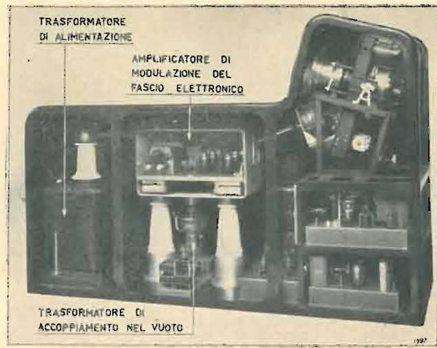
Fig. 5. - Vista interna del mobile di proiezione. Sono chiaramente visibili i grossi isolatori del trasformatore di alimentazione e dell'amplificatore di modulazione del fascio elettronico che ha un potenziale negativo di 80 kV rispetto alla massa.
